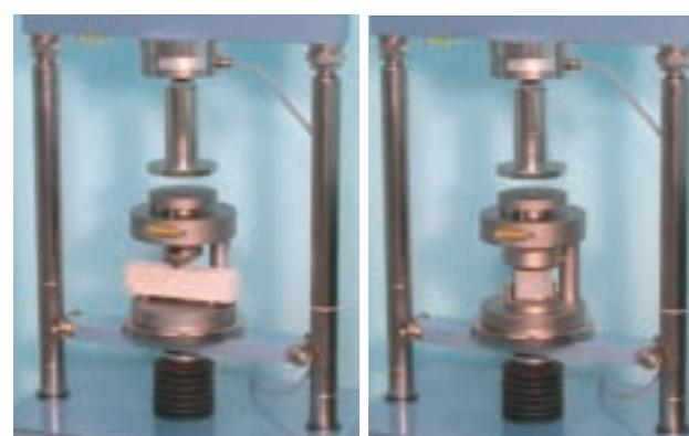
**Испытание цементных образцов на сжатие** (предел нагрузления 50 кН)
